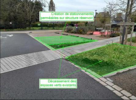
Création de stationnements perméables sur structure réservoir
