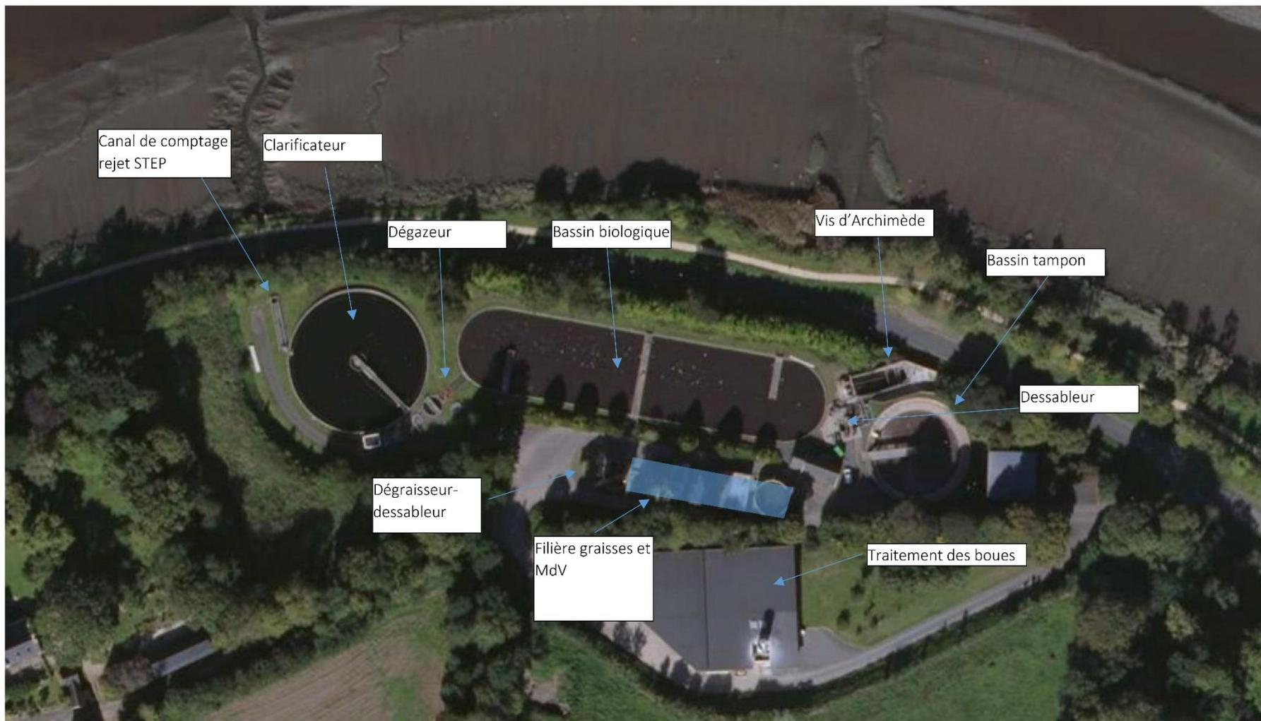
Figure 25 : Localisation des principaux ouvrages de la station d'épuration actuelle (source : LTC)
